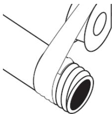
Le maintien de la bobine, comme indiqué sur le dessin ci-dessus, évite de trop dérouler de ruban lors de la mise en œuvre.
