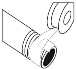
Le maintien de la bobine, comme indiqué sur le dessin ci-dessus, évite de trop dérouler de ruban lors de la mise en œuvre.
