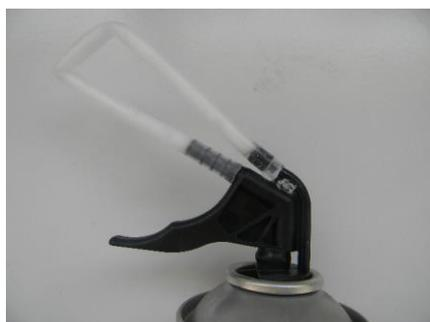
Au-delà, nous conseillons un nettoyage complet : démonter le bec extrudeur et nettoyer soigneusement toutes les parties (valve, bec et canule) avec le NETTOYANT MOUSSE PU 2 EN 1.
